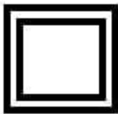
Matériel possédant une double isolation des parties actives (isolation fonctionnelle et matérielle). Cette double isolation garantit qu'aucune partie accessible ne peut être soumise à une tension dangereuse même à la suite d'un premier défaut d'isolement.
