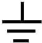
Matériel possédant une isolation fonctionnelle et une liaison à la terre des masses métalliques. Ces appareils doivent être raccordés à la terre.
